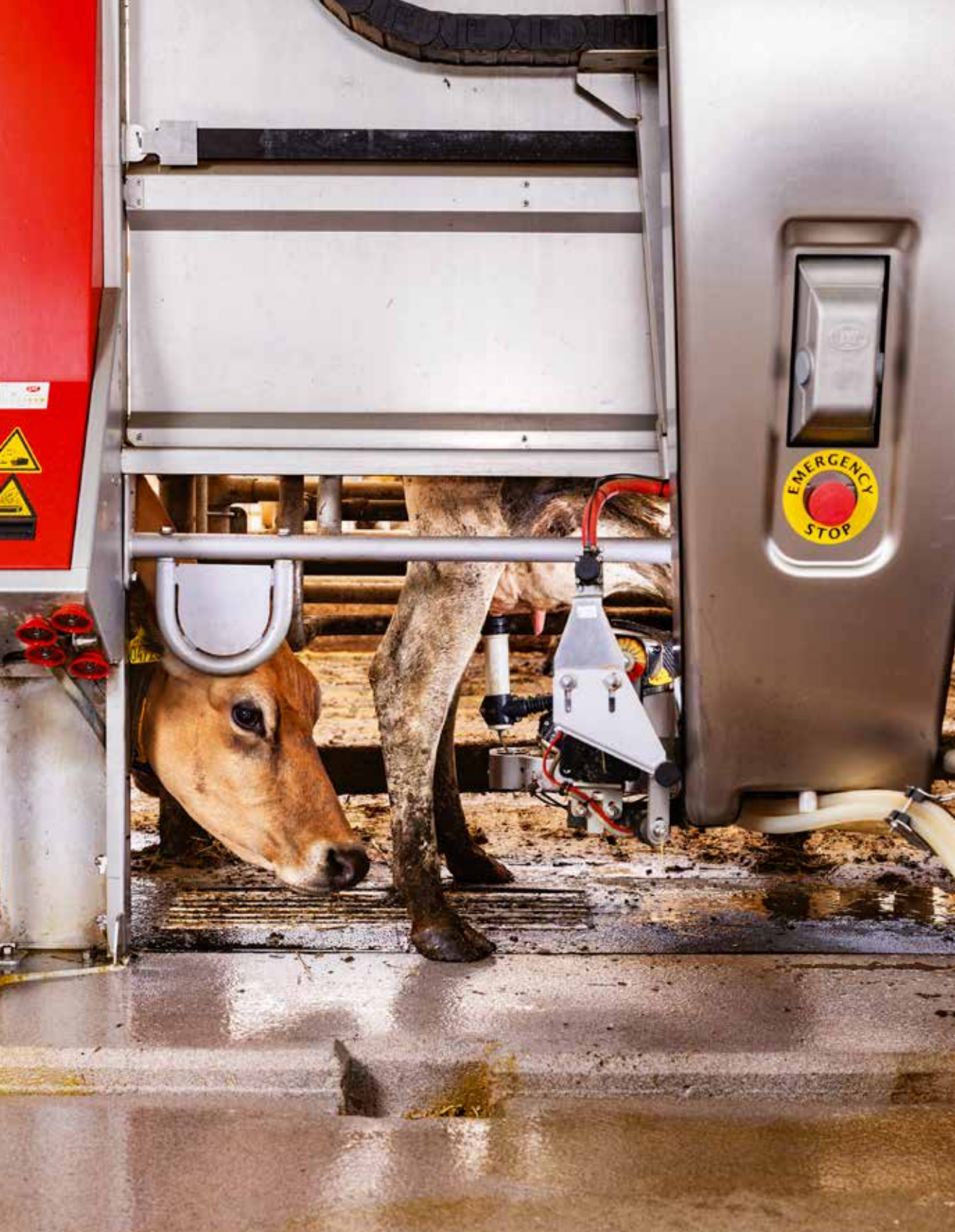
Een koe wandelt een volautomatische melkrobot in op de Henri Willig-kaasboerderij in Katwoude. Een medewerker kan de productie bijhouden en de robot via een touchpad instructies geven.
